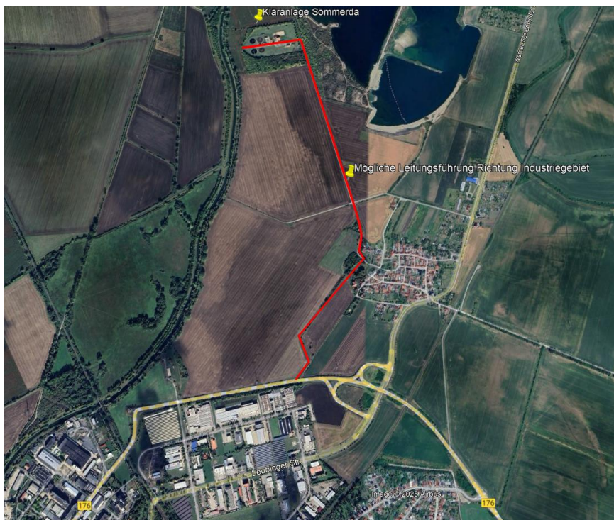
Abbildung 3-15: Distanz zwischen Wärmequelle und Wärmesenke der Abwasserwärmenutzung (Eigene Darstellung)
