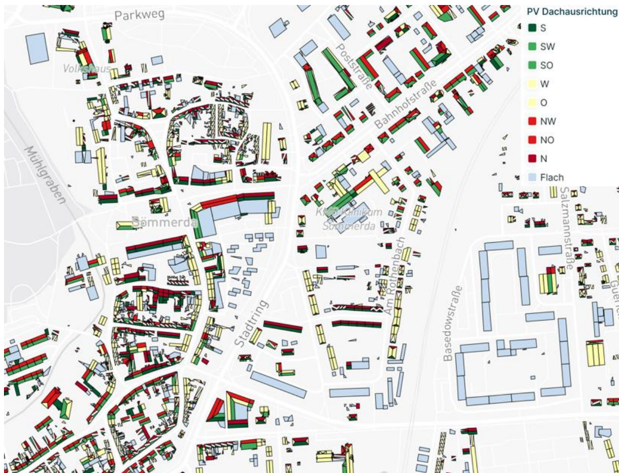
Abbildung 3-17: Potenzial von PV-Anlagen auf Dachflächen
